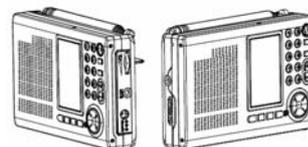
2. Para escuchar emisoras en FM utilice la antena orientable de 360°. Extienda la antena y ajuste su longitud y dirección hasta que obtenga una recepción óptima.
